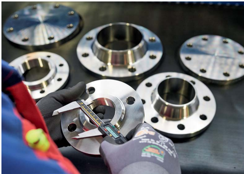
Die Materialqualität ist von entscheidender Bedeutung: Edelstahlflansche
