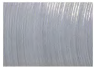
N8 R a 3,2 µm – AARH / CLA 125 R z 12,5 µm
